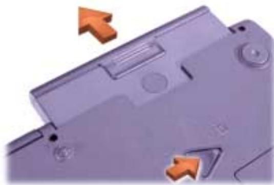
**6** Die neue Batterie bis zum Anschlag in das Batteriefach hineinschieben. Die Batterie rastet bei richtiger Installation hörbar ein.
